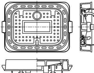
空気弁・消火栓室材 角型 内径 550×350
