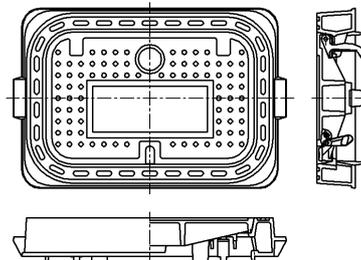
高さ傾斜調整柵(鋳鉄製)
