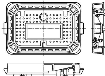
高さ傾斜調整柵(鋳鉄製)
